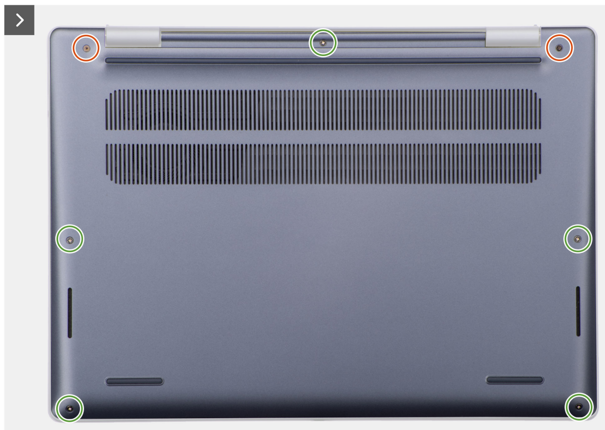
Rysunek 16. Wymontowywanie pokrywy dolnej
