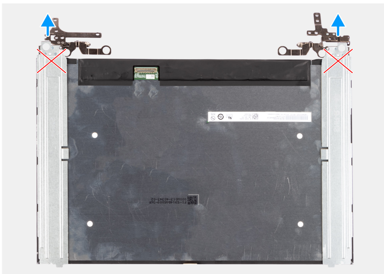
Rysunek 80. Wymontowywanie wyświetlacza
