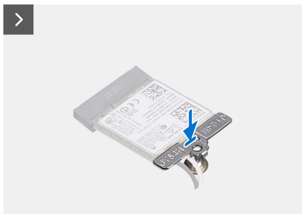
Rysunek 37. Instalowanie karty sieci bezprzewodowej
