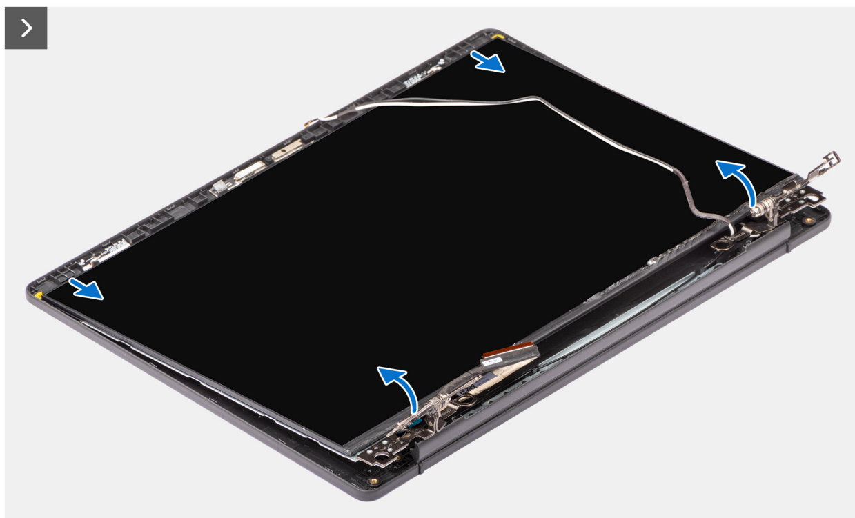
Rysunek 78. Wymontowywanie wyświetlacza
