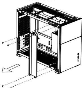
Remove Front Panel / Entfernen Sie die Frontplatte / Retirer le panneau avant / 移除前板
