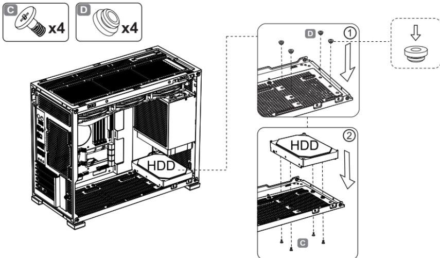
2.5" SSD Installation / 2,5-Zoll-SSD-Installation / Installation d'un SSD 2,5" / 2.5" SSD硬碟安裝
