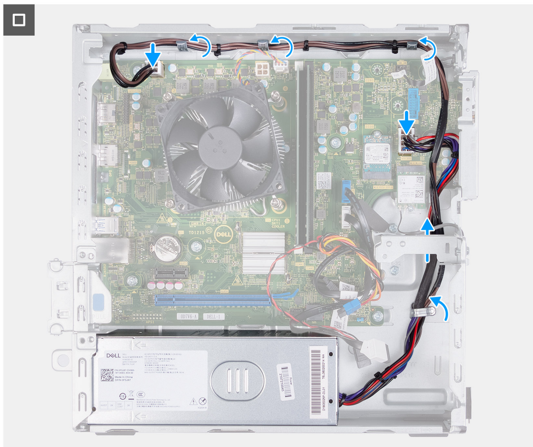
Rysunek 41. Umieszczanie kabli antenowych w prowadnicach
