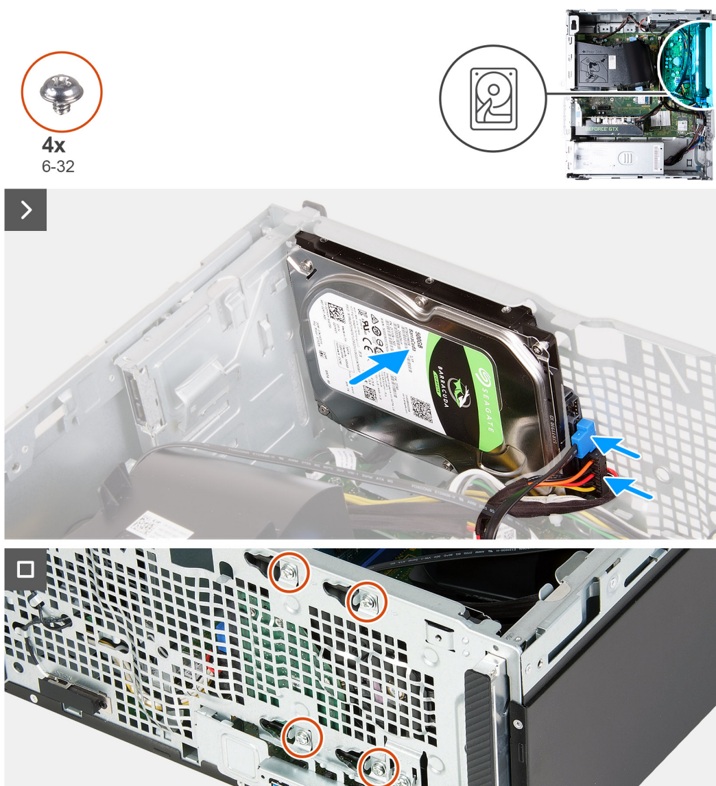
Rysunek 25. Instalowanie dysku twardego
