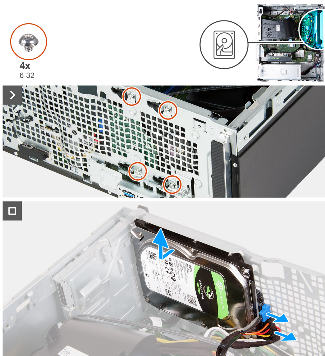
Rysunek 24. Wymontowywanie dysku twardego
