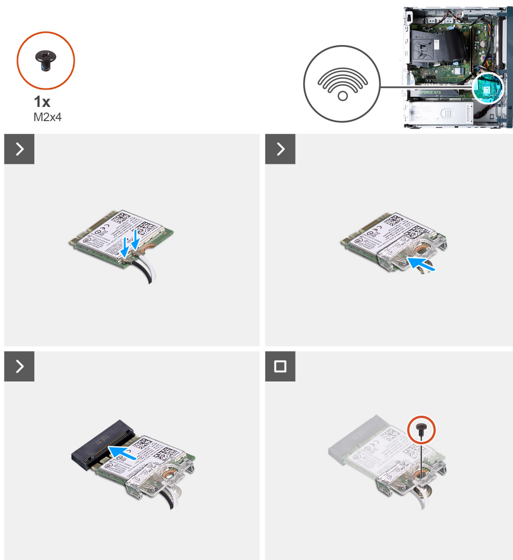
Rysunek 21. Instalowanie karty sieci bezprzewodowej
