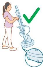
1 Nakloňte přístroj dozadu směrem k sobě a přesuňte jej pomocí koleček.
