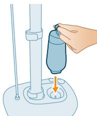
5 Insérez le réservoir d'eau dans la base.
