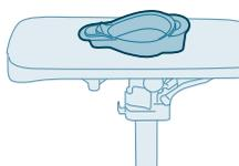
**13** Posicione o ferro sobre o contêiner do Calc-clean. Certifique-se de que a ponta do ferro se encaixe no protetor da ponta do contêiner.
