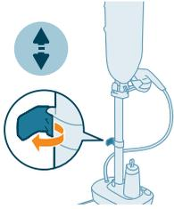
1 Lösen Sie den unteren Clip an der Stange.
