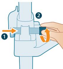
7 Insérez la tige dans l'axe de la charnière et serrez son bouton au niveau du raccord du mât.
