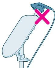
**10** Non posizionare il ferro sul supporto in posizione inclinata, poiché potrebbe cadere.
