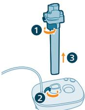
11 Vergrendel de klem van de onderste stang. Ontgrendel de klem van het basisstation. Trek de stang eruit.
