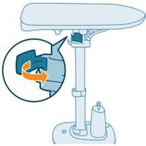
**11** Verriegeln Sie den Hebel zur Höhenverstellung.
