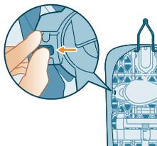
7 Pociągnij zatrzask zwalniający na zewnątrz, aby odłączyć pojemnik Calc-Clean.
