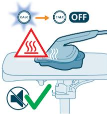
16 Wanneer de Calc-Clean-procedure is afgerond, stopt het strijkijzer met piepen en stopt het Calc-lampje met knipperen. Het strijkijzer wordt uitgeschakeld.
