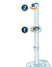
**4** Ontgrendel de kantelhendel van de strijkplank. Ontgrendel de klem van de bovenste stang.
