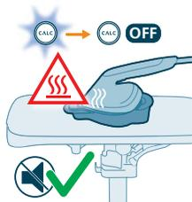
16 Når afkalkningen er færdig, holder strygejernnet op med at bippe, og Calc-indikatoren holder op med at blinke. Strygejernnet slukker.
