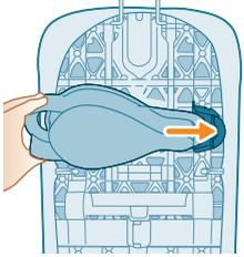
**19** Alinee e introduzca el recipiente Calc-Clean en la punta del soporte del recipiente en la parte posterior de la tabla de planchar.
