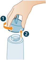
2 Schrauben Sie den Deckel des Wasserbehälters ab und entfernen Sie ihn.
