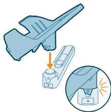
**15** Zasuňte dokovací stanici do ramene dokovací stanice, dokud neuslyšíte cvaknutí.
