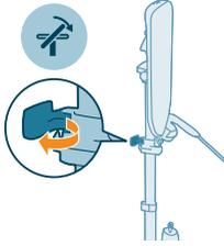
1 Desbloquee la palanca de inclinación de la tabla.
