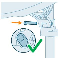
**13** Juster formen på den hængslede aksels stang efter Y-beslagets form. Indsæt den hængslede aksels stang gennem gennemgangshullet.
