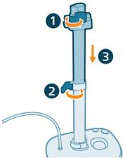
10 Ontgrendel de kantelhendel van de strijkplank. Ontgrendel de klem van de onderste stang. Duw de stang naar beneden.
