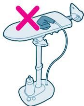
4 Ikke sett strykejernet på strykebrettet. Dampslangen kan trekke strykejernet ned slik at det faller på gulvet.
