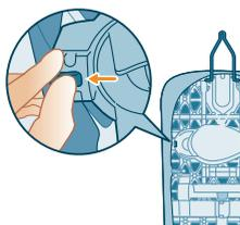
7 Povlecite zapah za sprostitev navzven, da snamete posodo za odstranjevanje vodnega kamna.
