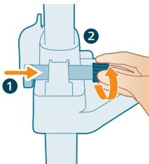
**7** Stecken Sie die Stange und den Scharnierkopf der Scharnierwelle wieder in den Anschluss an der Stange und ziehen Sie das Ganze fest.
