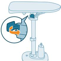
**11** Ontgrendel de kantelhendel van de strijkplank.
