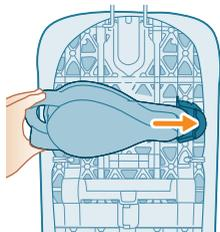
**20** Enfoncez le réservoir Calc-Clean dans le dispositif de déverrouillage, jusqu'à ce que vous entendiez un « clic » qui indique que le réservoir est fixé.
