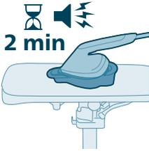
15 Tijdens de Calc-Clean-procedure hoort u korte piepjes en een pompend geluid. Wacht ongeveer 2 minuten tot de procedure is voltooid.
