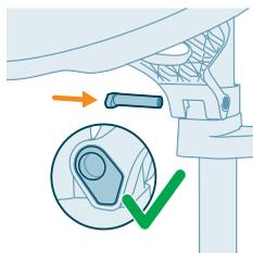
**13** Alinhe o formato da haste do eixo da dobradiça com o formato de inserção do suporte em Y. Insira a haste do eixo da dobradiça através do orifício de passagem.
