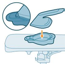
**13** Sett strykejernet på Calc-Clean-beholderen. Sørg for at strykejernfronten passer i beholderens frontbeskyttelse.
