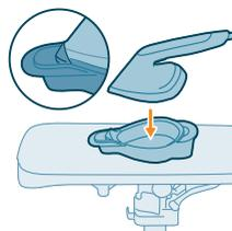
**13** Coloque la plancha sobre el depósito Calc-Clean. Asegúrese de que la punta de la plancha encaje en el protector de la punta del recipiente.
