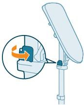
3 Bloquee la palanca de inclinación de la tabla.
