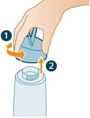
2 Desenrosque y retire el tapón del depósito de agua.
