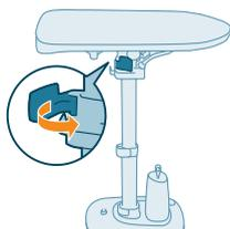
2 Vajutage triikraua dokihoova nuppu ja eemaldage triikraua dokk.
