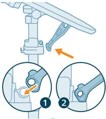
**12** Setzen Sie die Y-Halterung des Bügelbretts auf den Anschluss an der Stange. Das Durchgangsloch muss frei sein.
