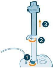
**2** Bloquee la pinza de la base. Desbloquee la pinza inferior del poste. Extienda el poste.
