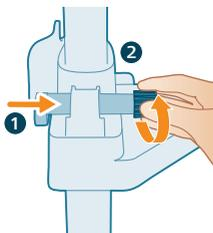
**7** Insira e aperte a haste e o botão do eixo da dobradiça de volta ao conector da haste.
