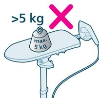
**13** Non posizionare sull'asse da stiro un carico superiore a 5 kg.
