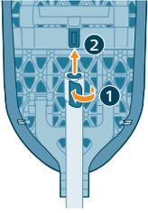
**8** Lösen Sie den oberen Clip an der Stange. Ziehen Sie das Bügelbrett heraus.
