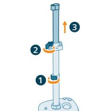
**3** Vergrendel de klem van de onderste stang. Ontgrendel de kantelhendel van de strijkplank. Schuif de stang uit.
