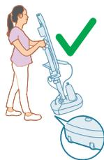
**1** Incline o aparelho para trás em direção ao seu corpo e empurre-o com as rodas.
