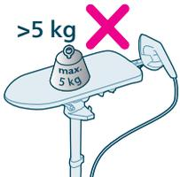
**13** Não coloque uma carga superior a 5 kg.
