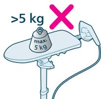
**13** Nemojte da pravite opterećenje veće od 5 kg.
