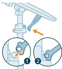
**12** Y-nosač daske postavite na konektor stupa. Otvor ne smije biti zapriječen.
