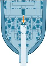
7 Introdu masa de călcat pe partea superioară a piciorului.
