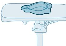
**13** Plaats het strijkijzer op het Calc-Clean-reservoir. Zorg ervoor dat de punt van het strijkijzer in de beschermingskap van het reservoir past.
