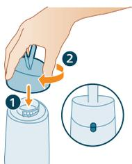
4 Vissez le bouchon du réservoir d'eau. Veillez à ce que l'indicateur soit aligné.
