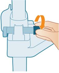
**10** Schrauben Sie den Scharnierknopf ab und entfernen Sie ihn.
