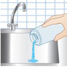
5 เติมน้ำออกจากแท่งค้เมื่อใช้งานเสร็จทุกครั้ง เพื่อป้องกันการสะสมตะกอนและคงประสิทธิภาพการทำงานของเครื่อง
