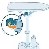
**11** Bloquee la palanca de inclinación de la tabla.
