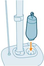
**17** Inserte el depósito de agua en la base.
