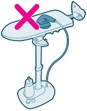
4 Laat het strijkijzer niet op de strijkplank staan. Het strijkijzer kan door de stoomtoevoer vallen.
