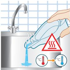
18 Als het Calc-Clean-reservoir tijdens de Calc-Clean-procedure heet wordt, laat het dan ongeveer 5 minuten afkoelen voordat u het aanraakt. Leeg het Calc-Clean-reservoir vervolgens boven de gootsteen en berg het op voor toekomstig gebruik.
