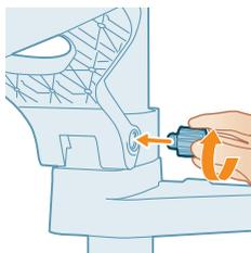
**14** Avvitare saldamente la manopola del perno.
