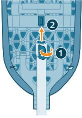
8 Atrakinkite viršutinį rėmo spaustuką. Ištraukite lyginimo lentą.
