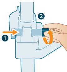
7 Steek de stang en de scharnierknop van de scharnieras terug in de paalverbinding en draai ze vast.
