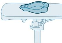
**13** Stellen Sie das Bügeleisen auf den Calc-Clean-Behälter. Stellen Sie sicher, dass die Spitze des Bügeleisens in den vorgesehenen Bereich im Behälter passt.
