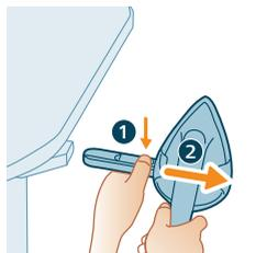
5 Нажмите кнопку на кронштейне крепления утюга, чтобы снять его. Удерживая утюг за ручку, извлеките крепление.
