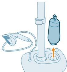
2 Scoate rezervorul de apă de pe bază.
