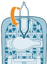
**3** Para colocar a peça de roupa na tábua de engomar na posição inclinada, vire o gancho do cabide para a parte traseira da tábua de engomar.
