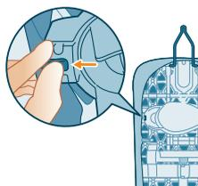
**7** Ziehen Sie die Entriegelung nach außen, um den Calc-Clean-Behälter abzunehmen.
