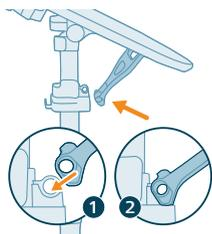
**12** Apoie o suporte Y da tábua de passar no conector da haste. O orifício de passagem deve estar desobstruído.
