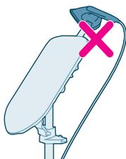
**10** Nie odkładaj żelazka w pozycji pochylonej. Może to spowodować wypadnięcie żelazka z podstawki dokującej.
