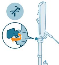
1 Entriegeln Sie den Hebel zur Höhenverstellung.
