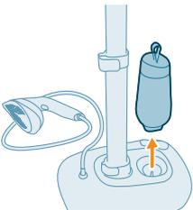
**2** Verwijder het waterreservoir van het basisstation.
