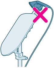
**10** Não coloque o ferro na base numa posição inclinada. Isso pode fazer com que o ferro caia da base.
