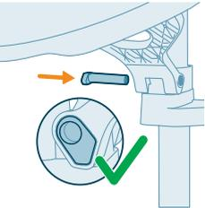
**13** Sejajarkan bentuk batang poros engsel dengan bentuk sisipan braket Y. Masukkan batang poros engsel melalui lubang.
