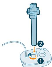
**1** Déverrouillez le clip de sécurité de la base et insérez le mât sur la base.
