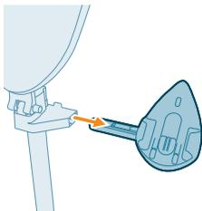
**3** Drücken Sie die Taste an der Bügeleisen-Halterung und ziehen Sie sie heraus.
