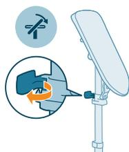
4 Entriegeln Sie den Hebel zur Höhenverstellung.
