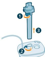
**11** Verrouillez le clip de sécurité du mât inférieur. Déverrouiller le clip de sécurité de la base. Retirez le mât.
