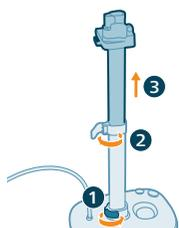
**2** Verrouillez le clip de sécurité de la base. Déverrouillez le clip de sécurité du mât inférieur. Déployez le mât.
