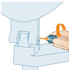
**4** Schrauben Sie den Scharnierknopf ab und entfernen Sie ihn.
