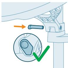
**13** Zarovnajte obrys tyčky hriadeľa so závesom s obrysom vložky konzoly v tvare Y. Vložte tyčku hriadeľa so závesom do priechodného otvoru.
