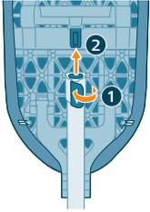
8 Ontgrendel de klem van de bovenste stang. Trek de strijkplank eruit.
