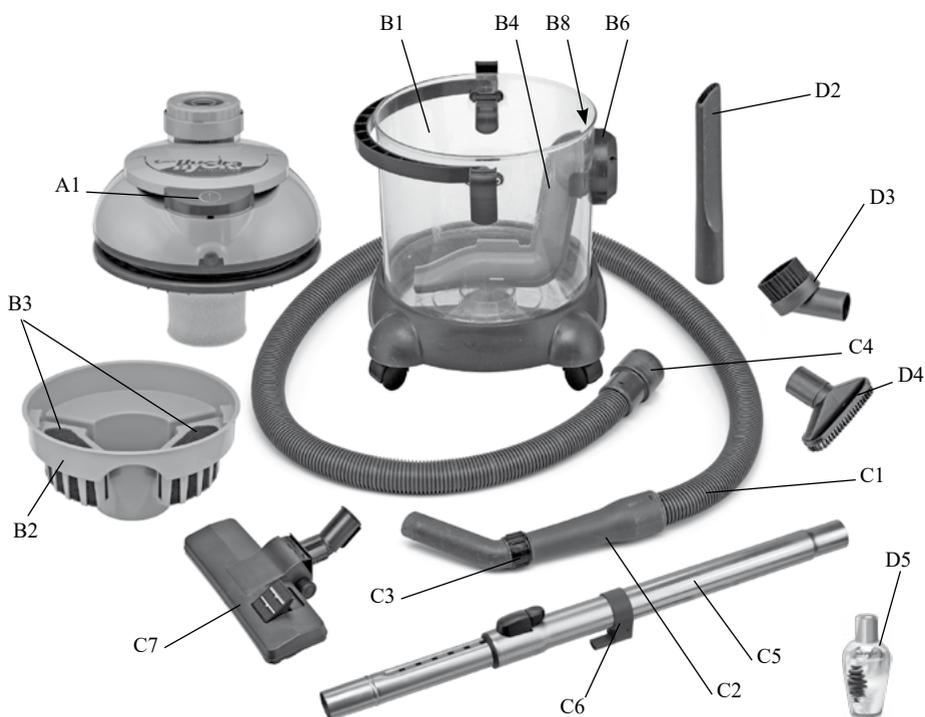
**A. Zespół silnikowy.** Ta sekcja obejmuje silnik, wyłącznik oraz elementy robocze. Górną część tej sekcji stanowi filtr HEPA służący do odfiltrowania kurzu oraz innych drobnych cząstek z wydychywanego powietrza. Pod filtrem piankowym umieszczony jest duży, plastikowy pływak który w miarę napełniania się pojemnika unosi się i odcina podciśnienie, tym samym ostrzegając o konieczności opróżnienia pojemnika
