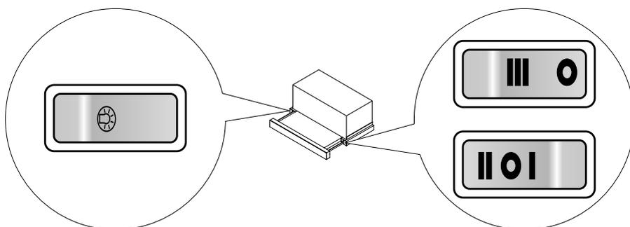
Komandna ploča je opremljena sa dugmadima (kolevka). Dugmad vidimo kad izvučemo teleskopsku čeonu ploču. Teleskopska napa je opremljena graničnim prekidačem. Svaki put kad izvučemo teleskopsku čeonu ploču napa počinje da radi u prethodno podešenoj brzini.
