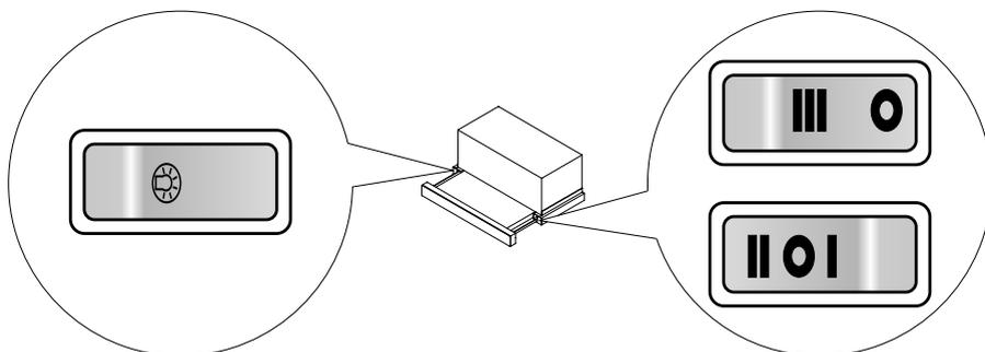
Ovládací panel má nasledujúce tlačidlá (vahadlo). Sú viditeľné po vysunutí teleskopického čela. Teleskopický odsávač má integrovaný koncový (dorazový) spínač. Keď vysuniete teleskopické čelo, odsávač sa spustí na predtým nastavenej rýchlosti.
