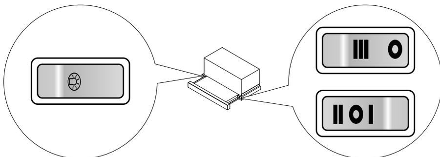
Панелът за управление е оборудван с бутони от тип rocker. Те се виждат след изтегляне на телескопичния фронт на абсорбатора. Телескопичният абсорбатор е оборудван с краен прекъсвач. Всеки път, когато изтеглите телескопичния фронт, абсорбаторът ще започне работа с последната зададена скорост.
