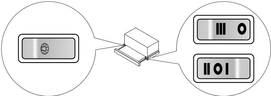
Az irányítópanel gombokkal rendelkezik (bölcső). Ezek a teleszkópos előlap kihúzását követően láthatók.
