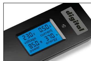
System monitorowania zużycia energii i parametrów zasilania z wyświetlaczem LCD
