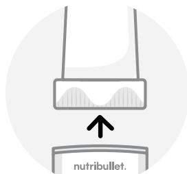
**2** Rimuovere il **bicchiere** e la **lama di estrazione rapida** dalla **base motore**.
