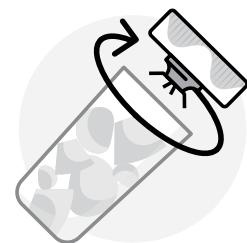
**4** Vissez la lame d'extraction rapide sur le gobelet nutribullet® jusqu'à ce qu'il soit hermétiquement fermé.
