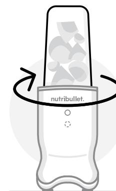
**7** Drehen Sie den **Becher** im Uhrzeigersinn auf dem **Motorsockel**, um ihn in seiner Position zu arretieren. (Ein „Klicken“ zeigt an, dass der **Becher** verriegelt ist). Das **Bedienfeld** schaltet sich ein.
