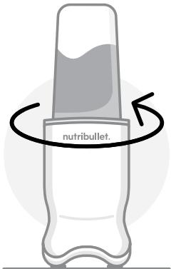
**9** Ruotare il **bicchiere** in senso antiorario per sbloccarlo e rimuoverlo dalla **base motore**. Quando il **bicchiere** si sblocca, si avverte un "clic". Godetevi il vostro frullato!
