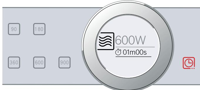
En la pantalla se muestra la potencia del microondas y una duración recomendada. El campo ② se ilumina en color rojo.
