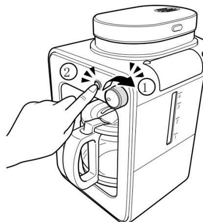
El proceso de preparación seguirá su curso hasta que el depósito de agua se agote. A continuación sonará el aparato una vez y el botón de arranque se iluminará con luz fija. El aparato pasará automáticamente al modo de mantenimiento de calor y después de 30 minutos el aparato se apagará automáticamente.
