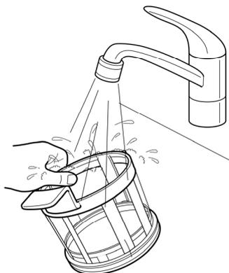
Очистите фильтр под проточной водой, после чего просушите.
