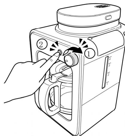
Le processus d'infusion se poursuit jusqu'à ce que le récipient d'eau soit vide. Ensuite l'appareil émet un bip et le bouton de démarrage reste allumé. L'appareil change de mode pour maintenir le café au chaud et la machine s'arrête automatiquement au bout de 30 minutes.
