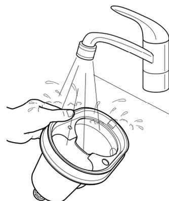
Нажмите на носик системы капля-стоп, промойте его под проточной водой, затем просушите.
