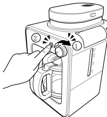
Het zetten gaat door totdat de watertank leeg is. Dan piept het apparaat een keer en brandt de startknop continu. Het apparaat gaat automatisch in de warmhoudmodus en wordt na 30 minuten automatisch uitgeschakeld.
