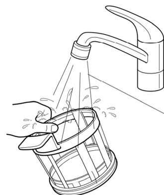
Retirez la cartouche filtrante ronde, nettoyez-la avec le couvercle sous l'eau courante et séchez-la. Remplacez la cartouche filtrante.
