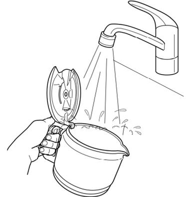
Runden Filtereinsatz abziehen, mit Deckel unter fließend Wasser reinigen und abtrocknen. Filtereinsatz wieder feststecken.
