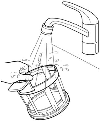
Filter onder stromend water reinigen en vervolgens afdrogen.
