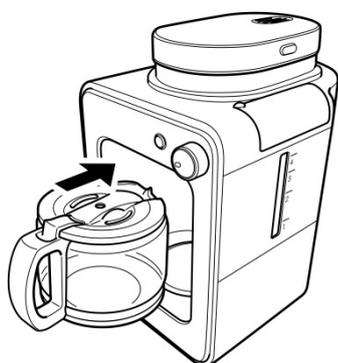
Coloque la jarra sobre la placa de mantenimiento del calor inclinándola ligeramente al introducirla.
