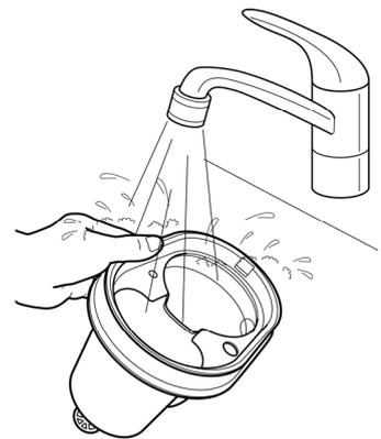
Filter unter fließendem Wasser reinigen und danach abtrocknen.
