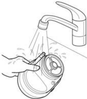
Ronder filterhouder eraf trekken, met deksel onder stromend water reinigen en afdrogen. Filterhouder vervolgens weer vastzetten.
