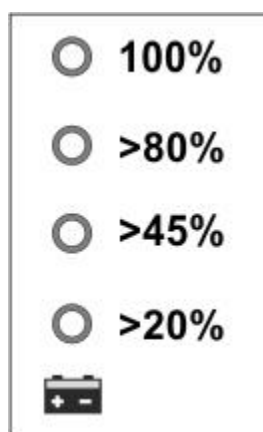
Rysunek 2: Stan naładowania / rozładowania akumulatora
