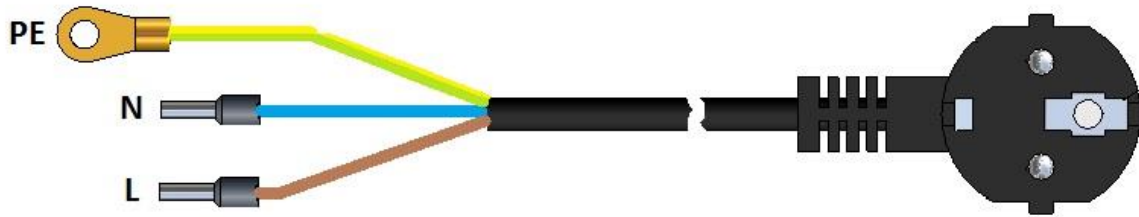
Rysunek 5: Sposób wykonania przewodu zasilającego
