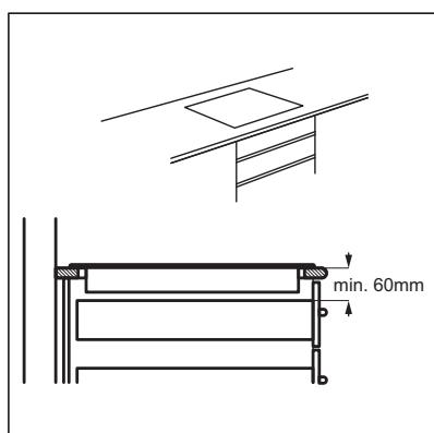
**i** Si el aparato se instala sobre un cajón, la ventilación de la placa puede calentar el contenido del cajón durante el proceso de cocción.
