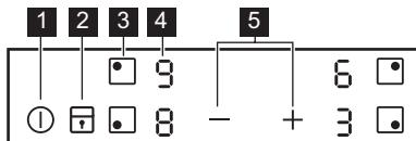
Napravo upravljalje s senzorskimi polji. Prikazovalniki, indikatorji in zvoki vas opozorijo na vklopljene funkcije.
