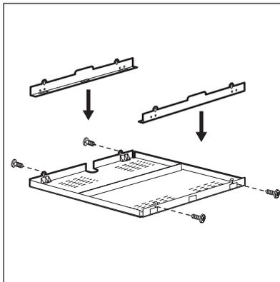
Če uporabljate zaščitno omarico (dodatna oprema), dvomilimetrski reza za pretok zraka spredaj in zaščitno dno pod kuhhalno ploščo nista potrebna. Zaščitna omarica morda ne bo na voljo v nekaterih državah. Obrnite se na krajevnega dobavitelja.
